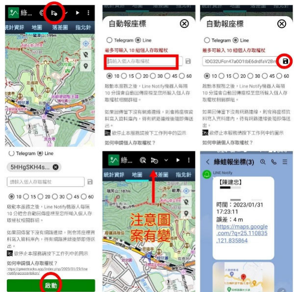
圖 11、設定綠野遊蹤傳 Line 自動報坐標方法：3. 開啟綠野遊蹤設定，貼上權杖，啟動後就會自動報坐標
